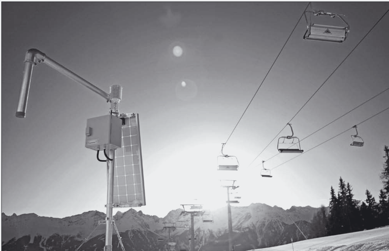
Oben: Schneemessstationen messen aktuelle Schnee- und Wetterdaten und übertragen sie live ins Internet. Unten: Messstation auf dem Neunerköpfl bei Tannheim. Fotos: Moser/Zobl
