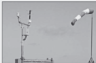
Oben: Schneemessstationen messen aktuelle Schnee- und Wetterdaten und übertragen sie live ins Internet. Unten: Messstation auf dem Neunerköpfl bei Tannheim. Fotos: Moser/Zobl
